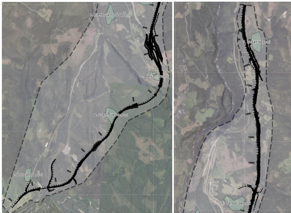
Figur 3 Utklipp fra GIS-modell med terrengfoto som viser planlagt veilinje med deponier
