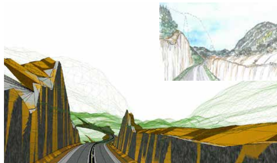
Fig 4.4: Større terrenginngrep kan bedre landskapsmessig forankring av veien i landformen rundt veien. Her det vist et eksempel på at skråningstoppen avrundes. Skisse: Wichada Tree-poonpon
