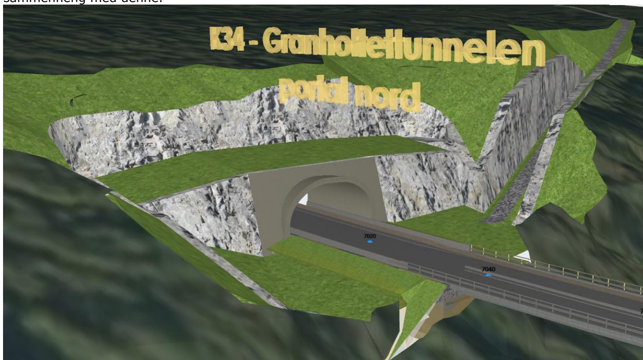
Figur 44 Illustrasjon av tunnelportalen med overgang til Orklabrua
