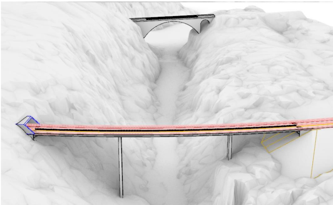
Figur 46 Illustrasjon av bjelkebru med jernbanebrua i bakkant.
