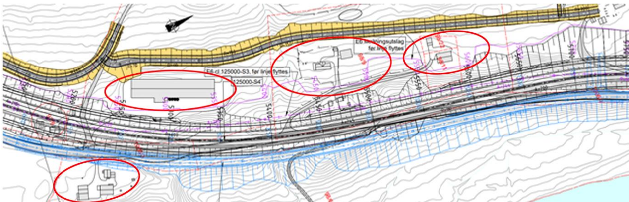
Figur 34 Reduserte eiendomsinngrep ved flytting av veillinje sørover (lilla linje viser utslagene fra tidligere skisse)
