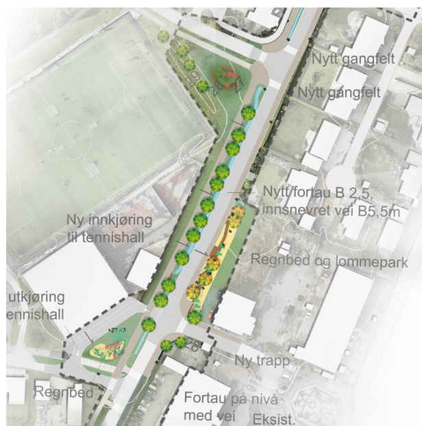
Eksempel på regnbed og parker langs kjøreveg som skaper funksjonelle og hyggelige strekninger. Foto: Sweco
